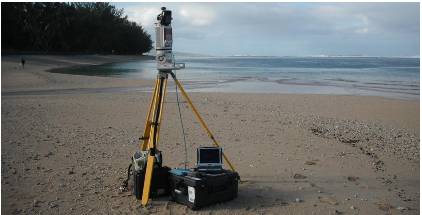
Scanner laser terrestre utilisé pour quantifier l'évolution topographique de la plage de l'Hermitage, La Réunion © Marion Jaud, Pôle image et Instrumentation de l'IUEM
