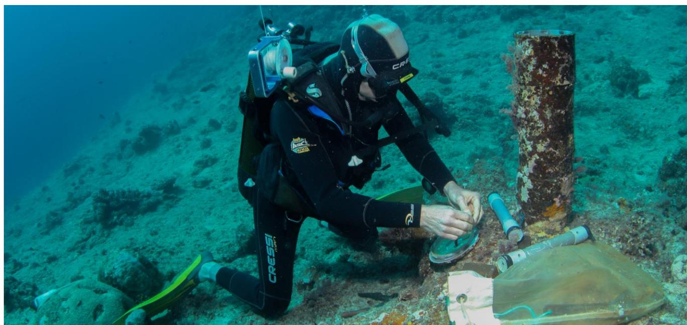
Relève des capteurs de température – Intervention de B.Bourgeois © IRD
