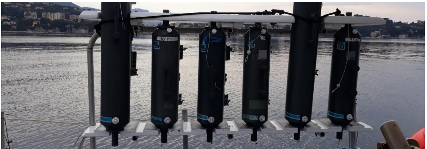
Bouteilles de prélèvement au point B de la rade de Villefranche © Maïa Durozier
