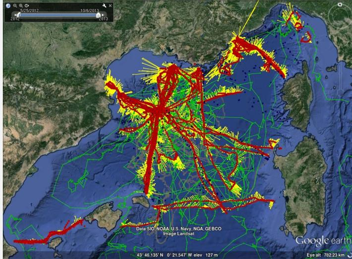
Étalonnage croisé pour T/S entre les différentes plateformes et harmonisation des fluoromètres avec les correspondances des couleurs océaniques par satellite. Références avec les mesures des navires (salinité et pigments)
