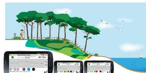
fig. 7 - Mesure d'altitude de points de mesures d'une tomographie électrique en environnement côtier via l'application ZheoPS-RTK Survey.
